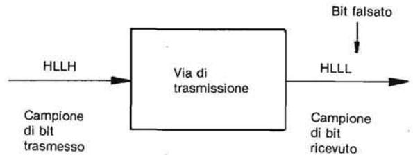
Fig. 11/18 - Trasmissione di informazioni difettosa.
